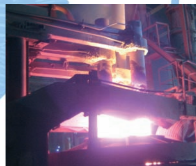
Raccolta polveri per forni elettrici ad arco in acciaierie, con accessori quali sistemi di raffreddamento e arresto scintille.
