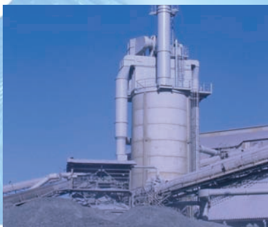
Raccolta polveri per trattamento minerario, ad esempio macinatori rotativi o a mascelle, impianti di selezione, nastri trasportatori, separatori d'aria, silos aspirati e stazioni di carico.
